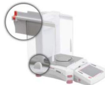
Подготовьте дверку к установке. Откройте фиксатор (сверху); установите дверку в верхний паз и сдвиньте нижний край дверки внутри нижнего паза. Закройте фиксатор.
