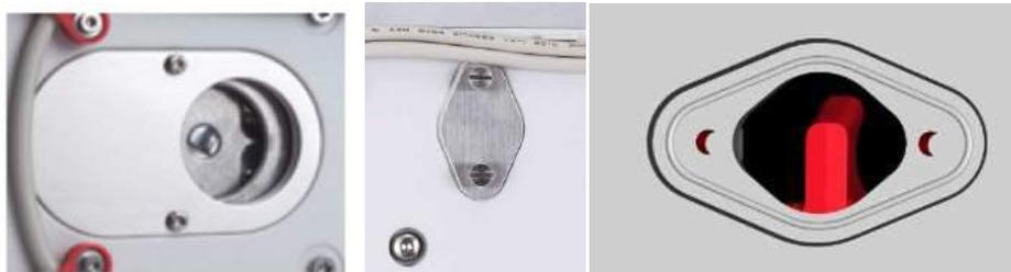
Весы можно установить на лабораторный подъемный столик или другую устойчивую горизонтальную поверхность. Установите весы по уровню. Включите весы; для крепления взвешиваемых предметов используйте отрезок струны или проволоки.
