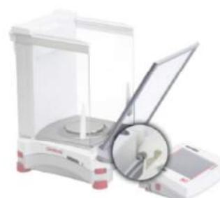
Нажмите кнопку, чтобы отсоединить терминал от весовой платформы. Совместите пазы панели с соответствующими выступами на весовой платформе. Поверните панель в вертикальное положение.
