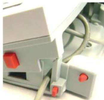
Проложите кабель принтера вдоль направляющих с нижней стороны весов. Кабель можно также вывести через прорезь рядом с кнопкой фиксатора терминала.
